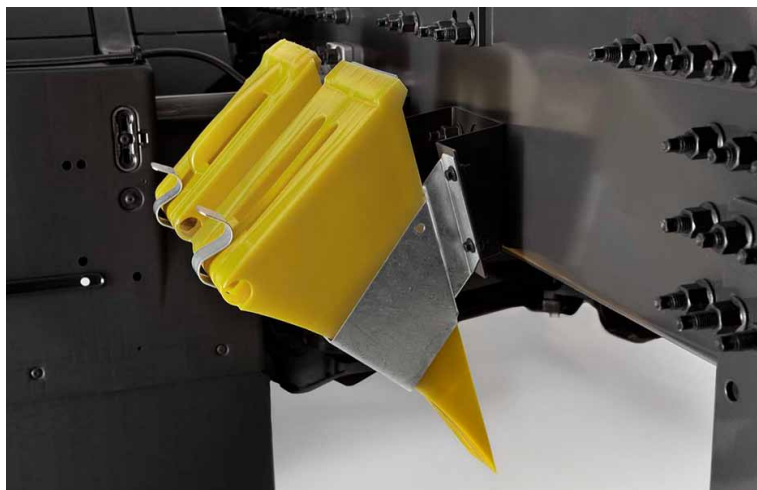
Dois calços de rodas fixos localizados à frente das rodas traseiras (WHC-FIX2+WHCP-M).
