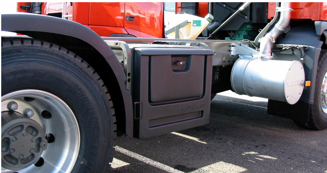
Caixa de ferramentas com fechadura montada no lado direito do chassis.
