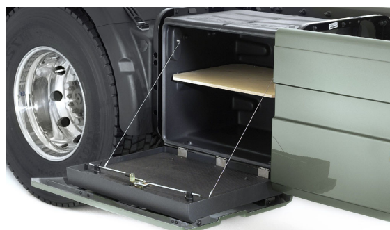
Caixa de ferramentas em combinação com saias laterais do chassis.
