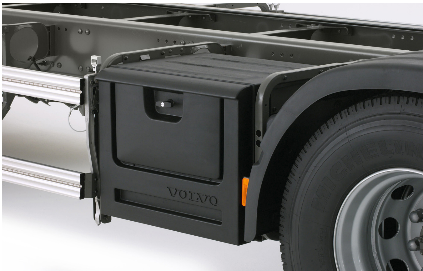
Caixa de ferramentas com fechadura montada no lado esquerdo do chassis.
