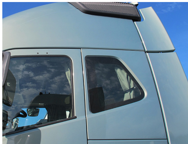
Janela lateral adicional, vista exterior.
