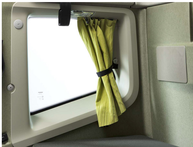
Janela lateral adicional, vista interior.
