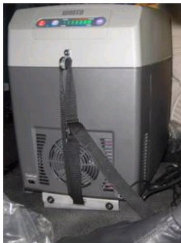
**A variante REF-ICPK é um suporte para instalação simples de um frigorífico no túnel do motor.**
