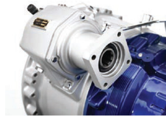
O posicionamento da tomada de força permite também a instalação de uma tomada de força montada no motor.
