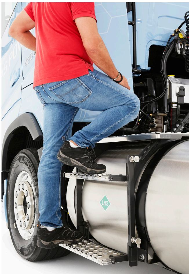
Enkel åtkomst till chassiet via utfällbara halksäkra fotsteg.
