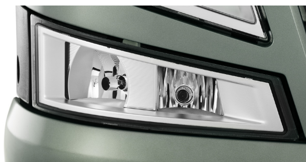
Die Zusatzeinheit mit Nebelscheinwerfern und Zusatz-Fernscheinwerfern oder statischem Abbiegelicht (links) und mit Nebelscheinwerfern (rechts).
