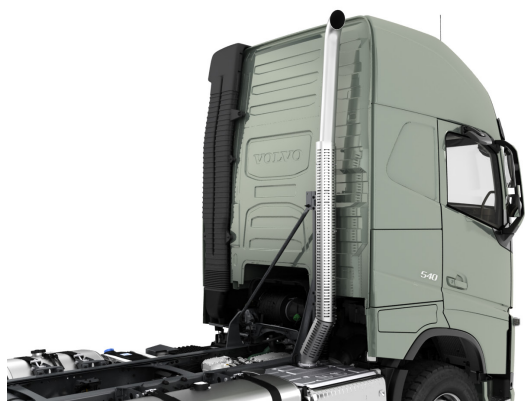
Saída de escape EXST-SSP com proteção térmica de escape EXSH e silenciador EASO-H para Volvo FH.
