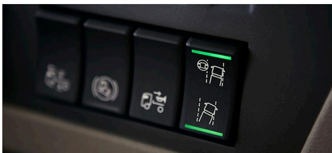
Управление функциями системы помощи в удержании полосы движения осуществляется с помощью переключателя на панели приборов.
