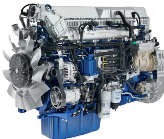
**O D13K500 é um motor diesel de 12,8 litros com 500 cv e 6 cilindros em linha, equipado com árvore de cames à cabeça, quatro válvulas por cilindro e injeção de combustível “common rail”. O motor cumpre os requisitos da norma Euro 6 relativos às emissões de gases de escape.**
