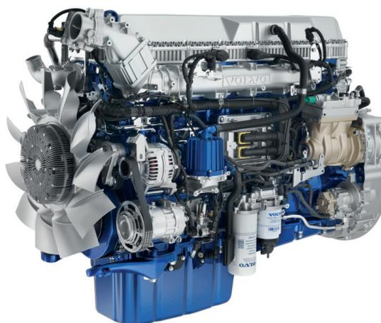
**Il D13K500 è un motore diesel a 6 cilindri in linea da 12,8 litri e 500 CV, dotato di albero a camme in testa, quattro valvole per cilindro e iniezione common rail. Il motore soddisfa i requisiti sulle emissioni allo scarico stabiliti dallo standard Euro 6.**
