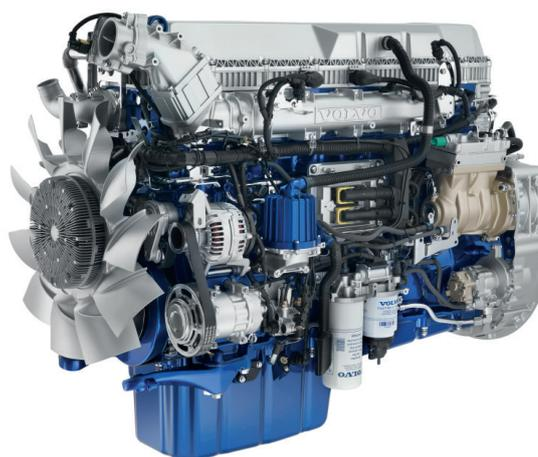
O D13K460 é um motor diesel de 12,8 litros com 460 cv e 6 cilindros em linha, equipado com árvore de cames à cabeça, quatro válvulas por cilindro e injeção de combustível “common rail”. O motor cumpre os requisitos da norma Euro 6 relativos às emissões de gases de escape.
