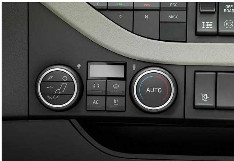
O painel de controlo da CU-ECC e da CU-ECC2 é lógico e fácil de utilizar. O funcionamento automático pode ser interrompido a qualquer momento.
