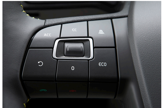
Botões para o cruise control CRUIS-E no volante. Botão ECO à direita. O nível Eco será definido com a roda ao meio.
