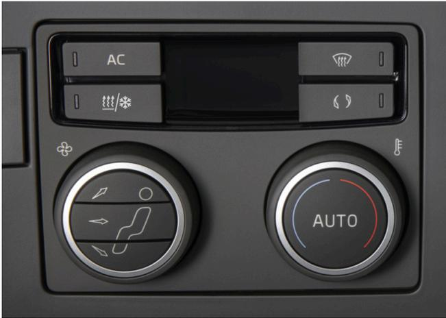
Die Fahrerhaus-Standklimaanlage kann über das Bedienfeld der Klimaanlage gesteuert werden.
