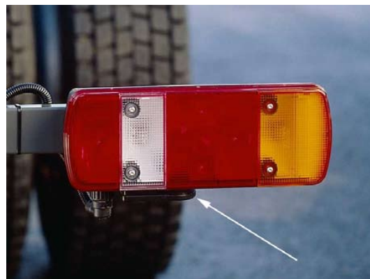
Farolim traseiro com alarme de marcha-atrás integrado.
