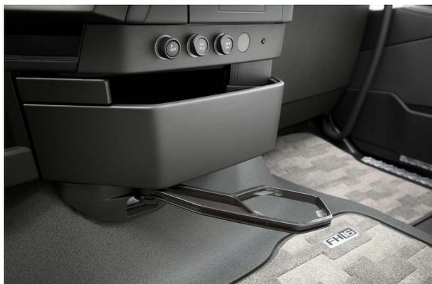
Porta-garrafas retráctil instalado debaixo do painel de instrumentos (FH).
