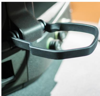
Porta-garrafas retráctil instalado no painel de instrumentos (FM).
