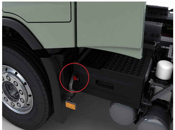
Interruptor principal para caixa de baterias na parte lateral do chassis (MSWI-C).
