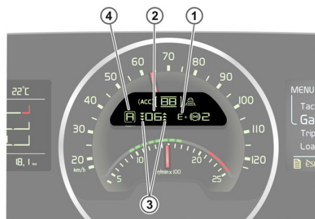
На дисплее отображается следующее. 1. Программа управления 2. Выбранная передача 3. Доступные передачи (вниз/вверх) 4. Положение рычага
