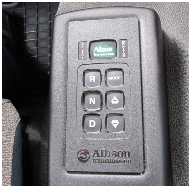
Sélecteur de vitesses à boutons-poussoirs - Volvo FE.
