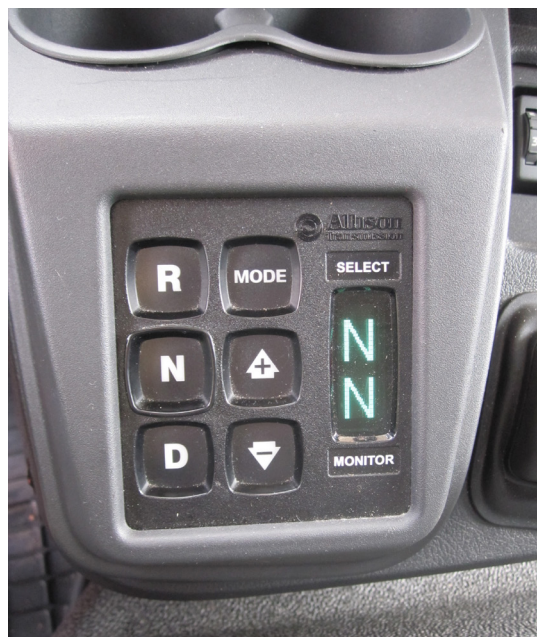
Sélecteur de vitesses à boutons-poussoirs - Volvo FL.
