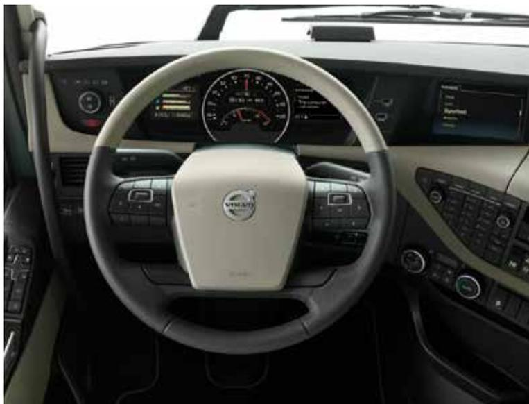
O airbag está instalado no módulo central do volante.
