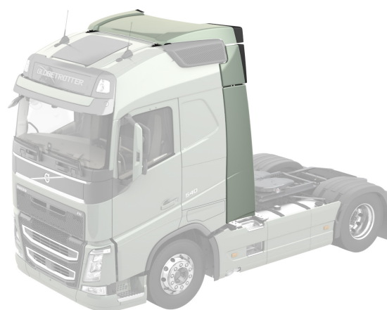
FH-HSLP, AD-SIDEL, AD-ROOF altura baixa
